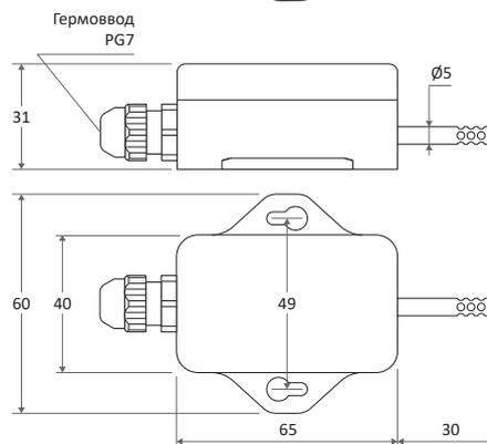
**Модель 2-10г** - применяется для измерения температуры воздуха в помещениях или на улице. Крепится саморезами или винтами. В клеммную головку может встраиваться преобразователь сигнала в 4-20 мА, 0-10В или RS485.
