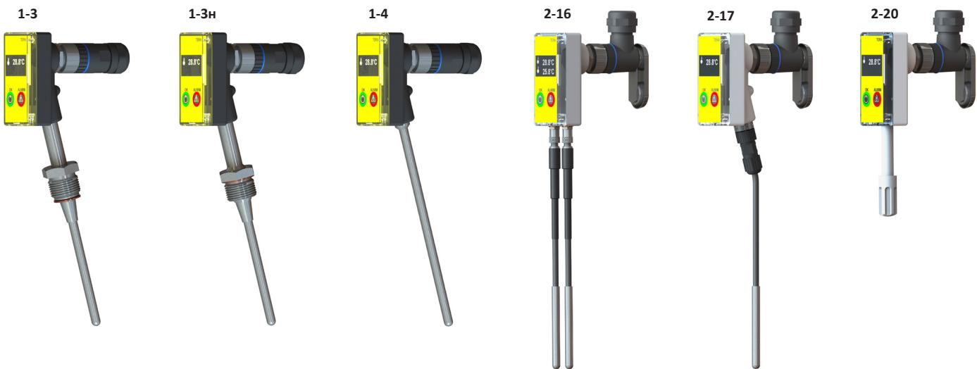
**Термоперетворювачі з виходом 4-20 мА** використовують аналоговий інтерфейс 4-20 мА для передачі даних. В залежності від моделі датчик підключається до дротової мережі 4-20 мА по 3-х або 2-х провідній схемі з живленням від зовнішнього джерела живлення. Для прокладки лінії рекомендується використовувати екранований кабель «вита пара». Підключення до лінії 4-20 мА здійснюється через герметичний різьбовий роз'єм M12 з гвинтовими клемами всередині (пайка не потрібно).
