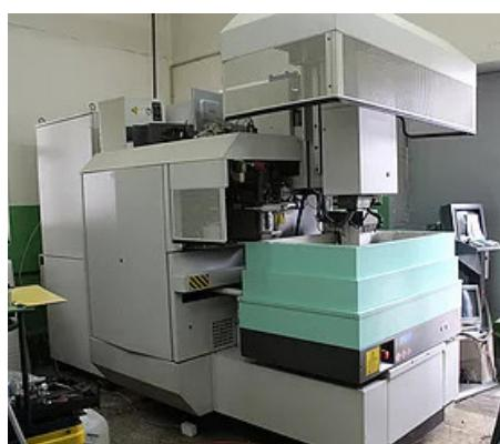
Ерозіонно-прошивний станок з ЧПК
