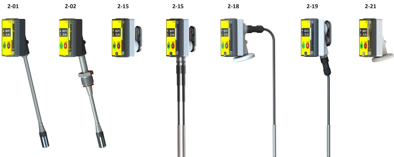
**Бездротові перетворювачі температури і відносної вологості повітря ZigBee 868** (далі - датчики) використовують інтерфейс ZigBee і радіочастоту 868 МГц для передачі даних. Датчик працює за принципом: прокинувся, вимірював, передав, заснув. Іншими словами, чим частіше йде вимірювання, тим більше витрачається заряд батареї. Для роботи з датчиками необхідний реєстратор-вебсервер CS10600 і бездротовий координатор мережі Y6.05-K-868.
