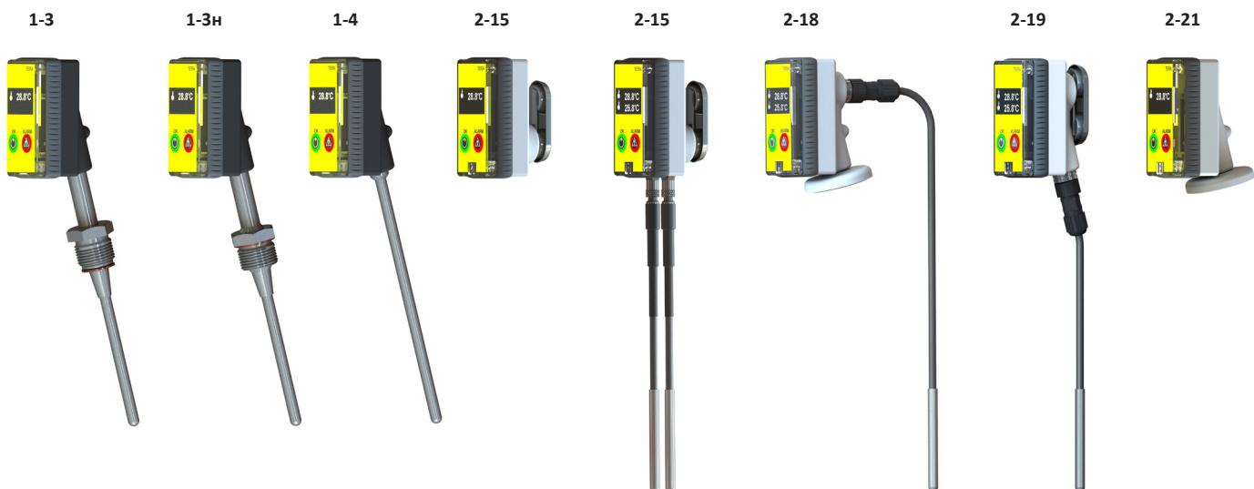
**Бездротові термоперетворювачі ZigBee 868** (далі - датчики) використовують інтерфейс ZigBee і радіочастоту 868 МГц для передачі даних. Датчик працює за принципом: прокинувся, вимірював, передав, заснув. Іншими словами, чим частіше йде вимірювання, тим більше витрачається заряд батареї. Для роботи з датчиками необхідний реєстратор-вебсервер CS10600 і бездротовий координатор мережі Y6.05-K-868.
