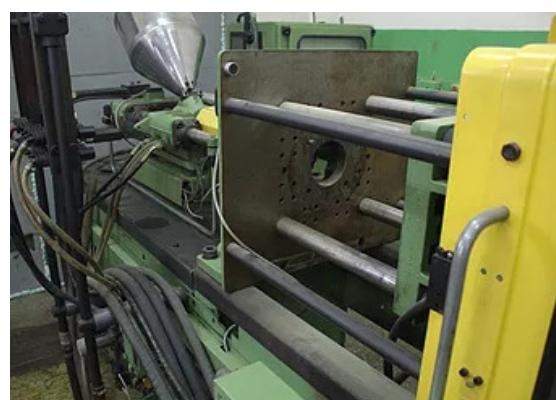
Термопластиковий автомат для ліття пластмас
